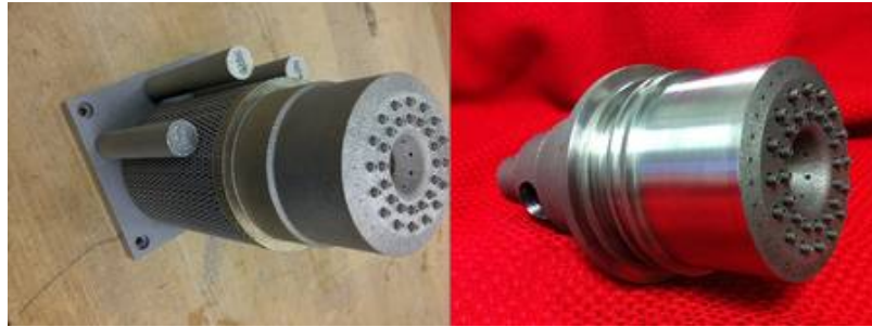
Sur la gauche, l'injecteur fabriqué par impression 3D juste après sa sortie de la machine. Sur la droite, le même injecteur après avoir été travaillé et poli. © Nasa, MSFC
