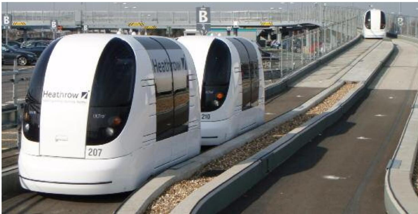
Les véhicules autonomes de l'aéroport d'Heathrow en Grande Bretagne ont leurs propres voies.
